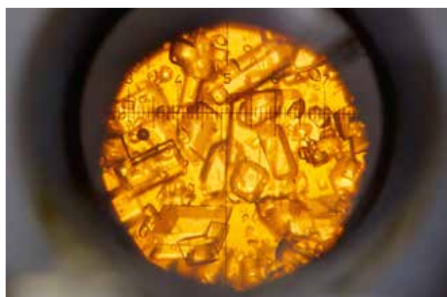
Unter Vakuum wird dem gewonnenen Dicksaft Wasser entzogen. Dabei beginnen erste Zuckerkrystalle zu wachsen.
